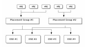
La CRUSH Map contient la carte de réplication des données sur les OSDs et permet, pour un PG donné, de déterminer automatiquement les OSDs de stockage.
